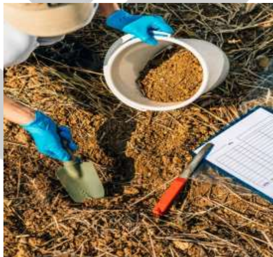
شکل ۱- نمونه برداری از خاک جهت انجام آزمون خاک
