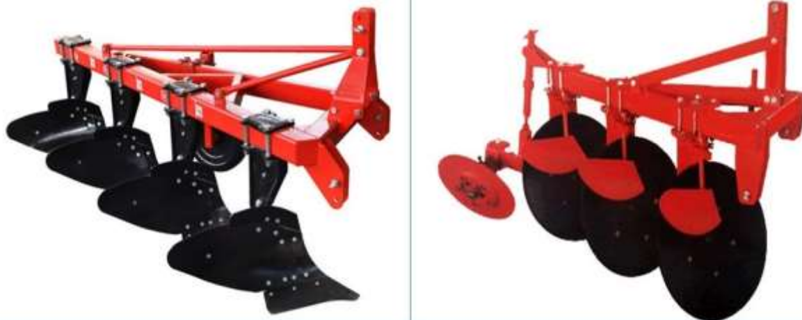
شکل ۸- گاوآهن برگرداندار (سمت چپ)، گاوآهن بشقابی (سمت راست)
