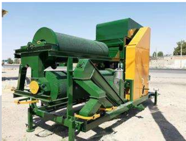
شکل ۲- دستگاه بوجاری بذر
