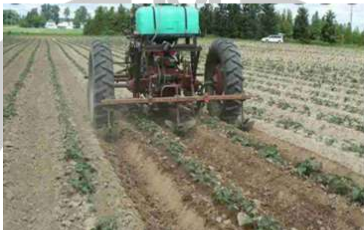
شکل ۲- کولتیواتور زدن علف‌های هرز
